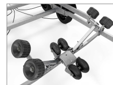
Förstärkt självjusterande vaggas med kölrullar
