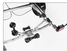
Förstärkt självjusterande vaggva med kölrullar
