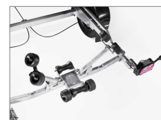
Förstärkt självjusterande vaggas med kölrullar
