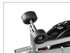
Dubbla multijusterbara X-line-sidorullar bak
