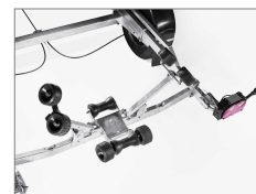
Förstärkt självjusterande vagger med kölrullar
