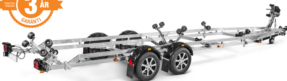
Förstärkt självjusterande vaggas med kölrullar
