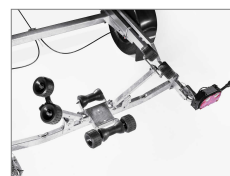
Förstärkt självjusterande vagger med kölrullar
