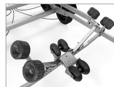
Förstärkt självjusterande vagger med kölrullar
