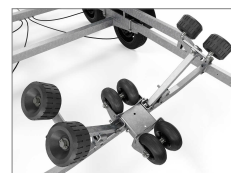
Förstärkt självjusterande vagger med kölrullar
