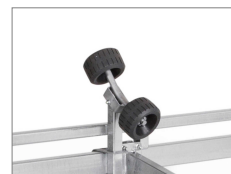
Dubbla multijusterbara X-line-sidorullar fram
