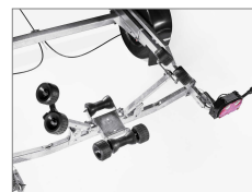
Förstärkt självjusterande vagger med kölrullar
